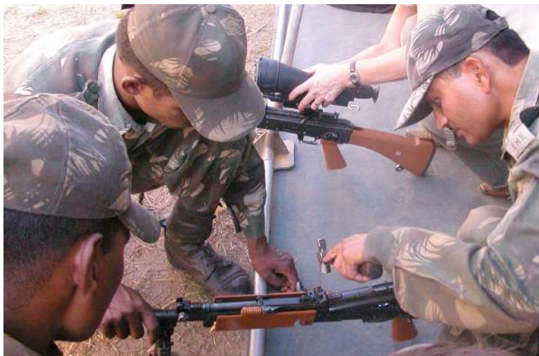
Боец подгоняет молотком крышку ствольной коробки. Надпись ЕМЕ на его погонах означает принадлежность к техническому подразделению (Electronics and Mechanical Engineers).
